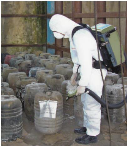
HAPSITE ER は、PPM（百万分の 1）～PPT（1 兆分の 1）のレベルの試料を検出できる機能を備えています。GC カラムは高い分解能を有しシャープなクロマトグラムが得られます。定量分析のメソッドの実行時には、存在する化学物質の種類やその濃度、および危険度に関する情報へのアクセス方法をフロントパネルにわかりやすく表示し、生命や健康、および安全に関わる速やかな意思決定をサポートします。
