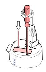
タクトスイッチを丸ピン( $\phi \approx 3$  mm)で押しながら、1.5 mm ドライバで< HV >電位差計を次のように調整します。
